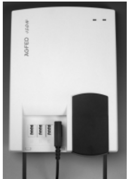
Abb. 4: TK-Anlage mit gesteckter Stromversorgung, ISDN-Anschluss und TAE-Stecker
